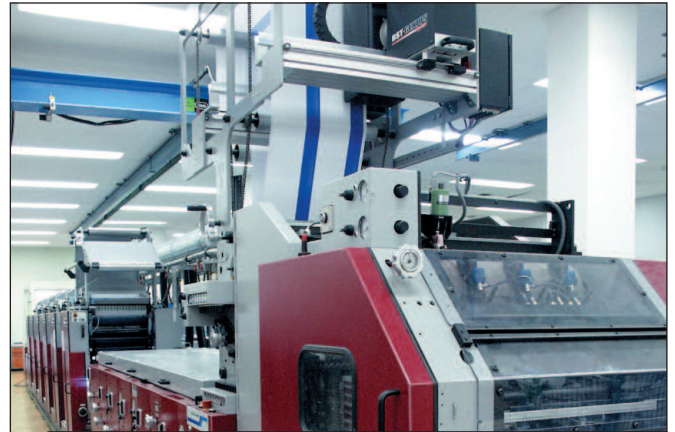
InkZone-Production liefert bei Conzett+Walter die Zonenwerte für die Farbsteuerungssysteme BST Monigraf an einer A52 (Bild) sowie GMI Microcolor an einer Concept von Müller Martini.
